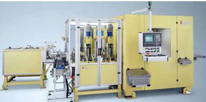
Vollautomatische Schweißanlage für PKW-Getriebeteile. Zuführen, Verpressen und zweiseitiges Schweißen der Teile mit Schweißnahtprüfung im laufenden Prozess.
