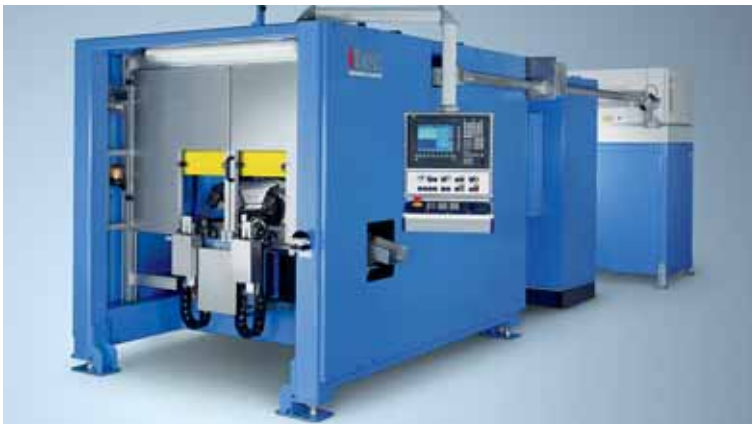
Laserschweißanlage für Pkw-Schaltgabeln. Hauptzeitparalleles Bestücken und Schweißen der Schaltgabeln.
